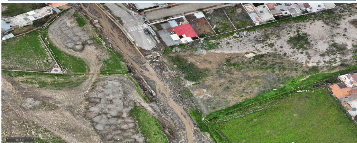
IMAGEN 04: SE VISUALIZA LA COLMATACION Y LA EROSION DE LOS MUROS PARA DEMOLICION Y RECONSTRUCCION DEL MISMO.
