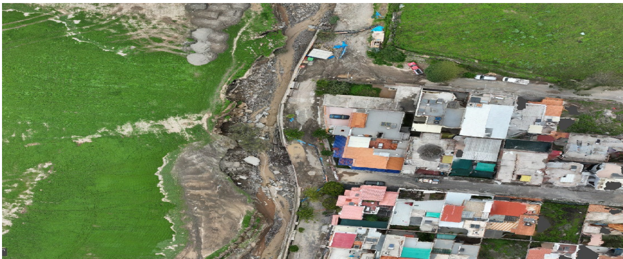
IMAGEN 03: LA VISTA SATELITAL ACTUAL MUESTRA LA EROSION POR FLUJO DE DETRITOS EN LA MARGEN DERECHA DE LA QUEBRADA CHULLO
